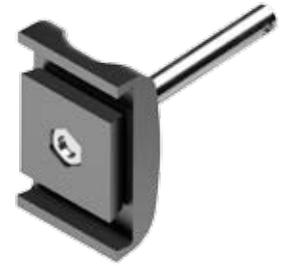
الخامات: أداة تثبيت من البولي أميد المقوى، مسمار، صامولة وحلقة معدنية من الفولاذ المقاوم للصدأ. المواصفات: يتم توريدها بمسار الدعم أو بدونه. تستخدم لدعم الدلائل الجانبية المستديرة القطع رقم 353, 377, 418, 419, 420, 446, 469, 485, 514. العبوة: 24 قطعة.
