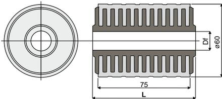
材質: 黒色、ポリアミド製の内軸、灰色、HS65、PVC (ポリ塩化ビニル) 製の外周。
