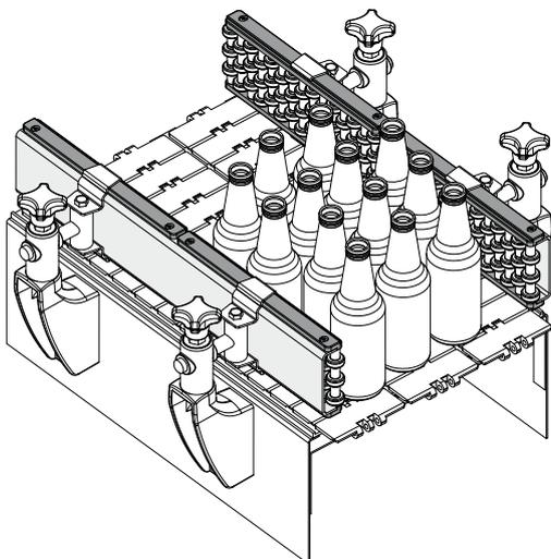
**Боковая направляющая с шариковыми роликами**
