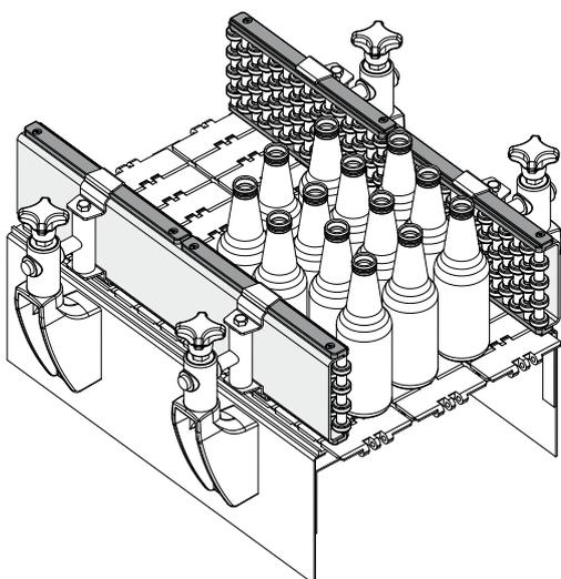
**Боковая направляющая с шариковыми роликами**
