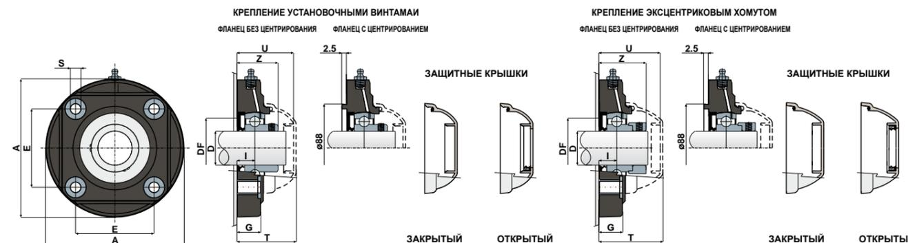
КРЕПЛЕНИЕ УСТАНОВОЧНЫМИ ВИНТАМИ - ФЛАНЕЦ БЕЗ ЦЕНТРИРОВАНИЯ
