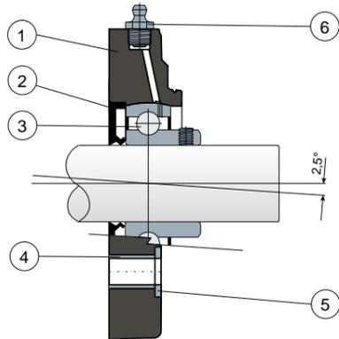
Крепление эксцентриковым хомутом - Полная защита подшипника
